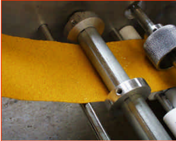
ABB 2: Einfädeln der Folie
