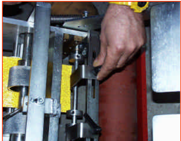
ABB 5: Justieren der unteren Folienführung
