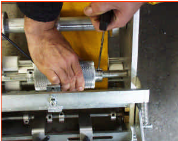
ABB 4: Justieren der Vorschubrolle in die Folienmitte
