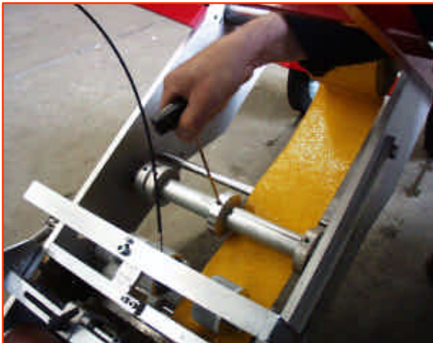
ABB 2: Einfädeln der Folie
